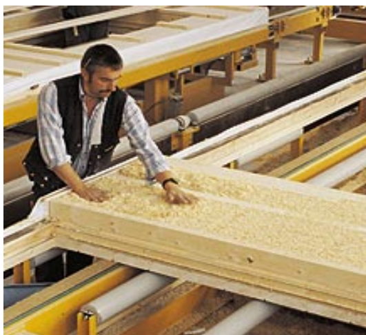
Figur 4: Isolering med rensed kutterflis på typehusfabrikk i Tyskland. Foto: Baufritz
